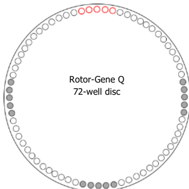
Abbildung 2: Pipettierschema für Rotorcycler am Beispiel der 72-well disc, Qiagen Rotor-Gene Q
